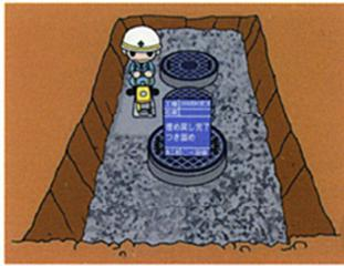
⑬ 埋め戻し完了、つき固め
