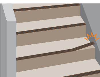
階段の滑り止めの浮き
