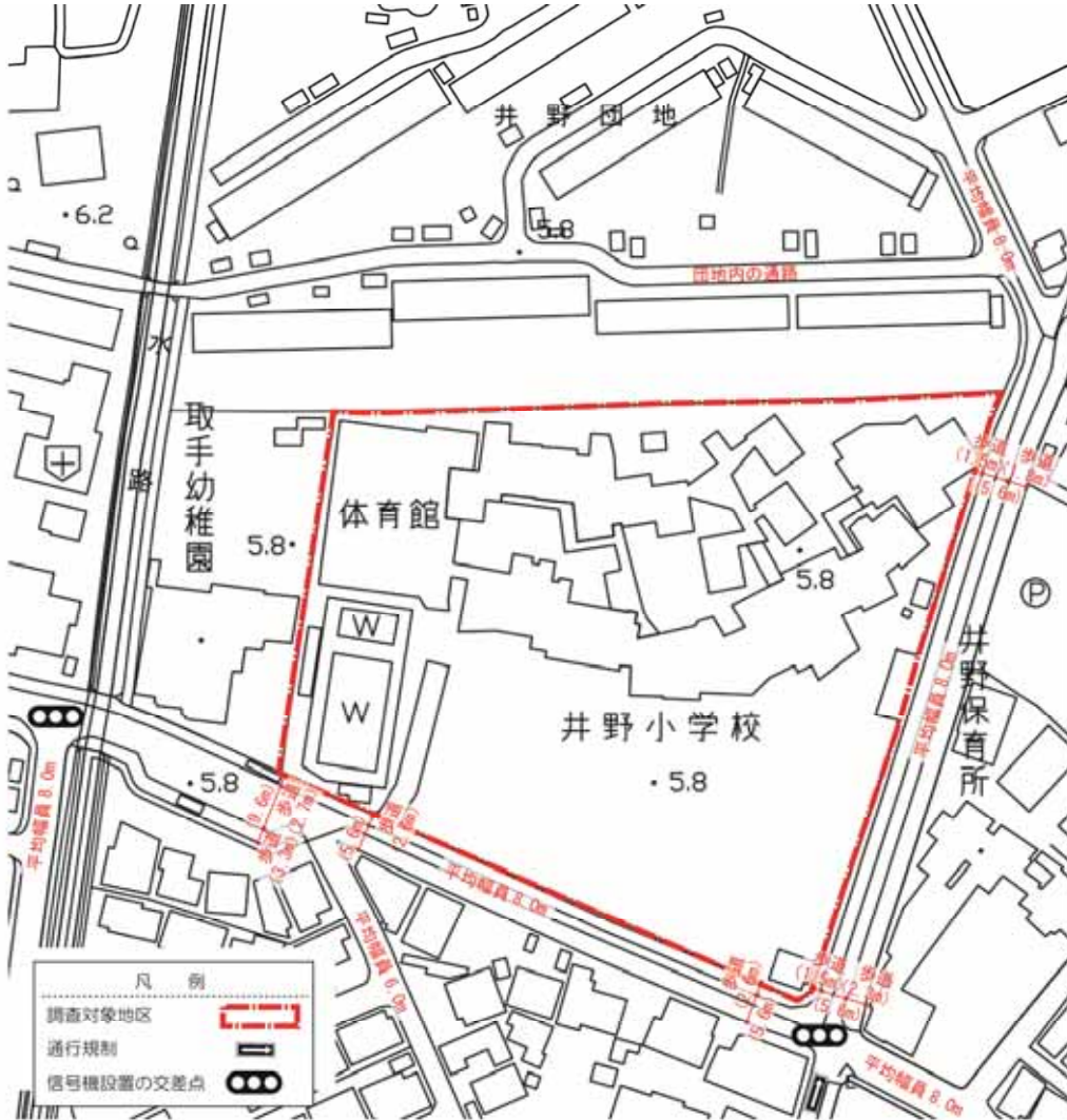
図 1-9 前面道路の幅員と交通規制
