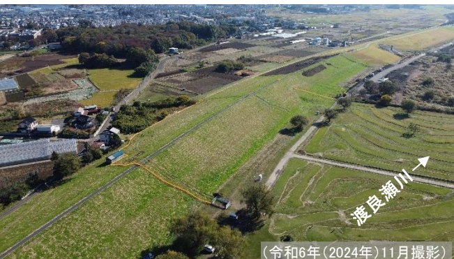
川表、裏断面拡幅・堤防かさ上げ状況(茨城県古河市新久田地先)
